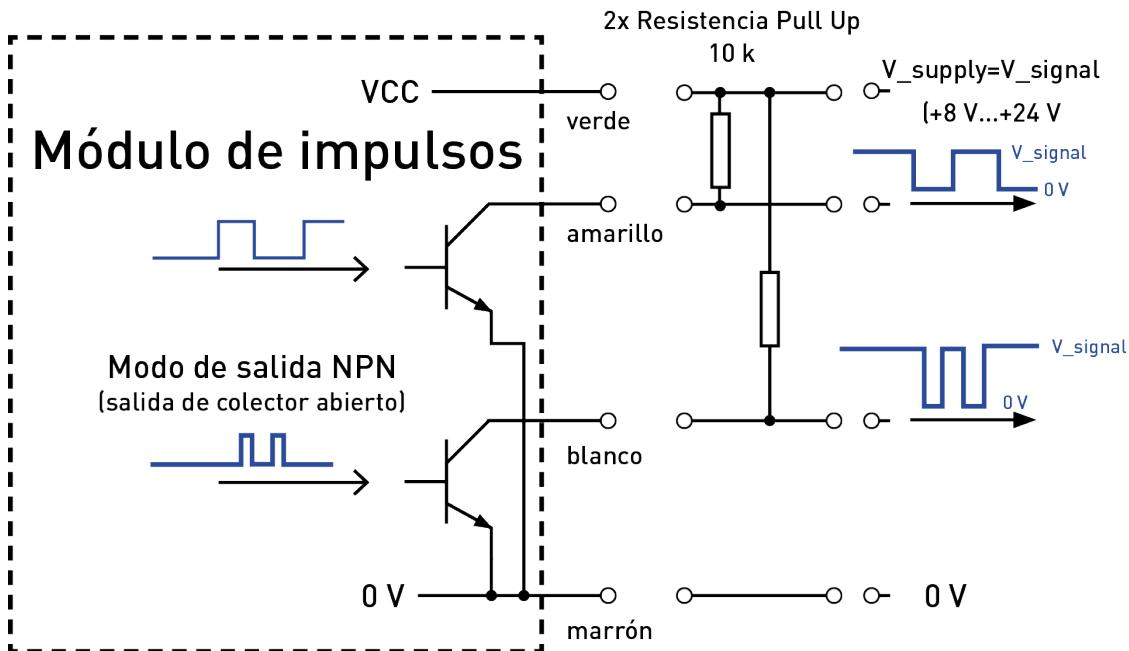
Se requieren resistencias de pullup (típ. 10K), bien en el extremo del cable suministrado (accionamiento activo) o en la unidad colectora de impulsos externa (modo pasivo).
