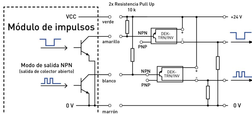
Además de las resistencias pullup, se necesita un convertidor de señal NPN a PNP.
