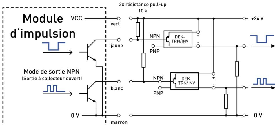
En plus des résistances pull-up, un convertisseur de signaux NPN à PNP est nécessaire.
