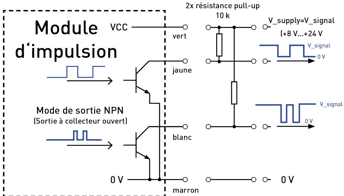
Résistances pull-up sont nécessaires (typ. 10K), soit à l'extrême du câble fourni (actif), soit dans le collecteur d'impulsions externe (mode passif).
