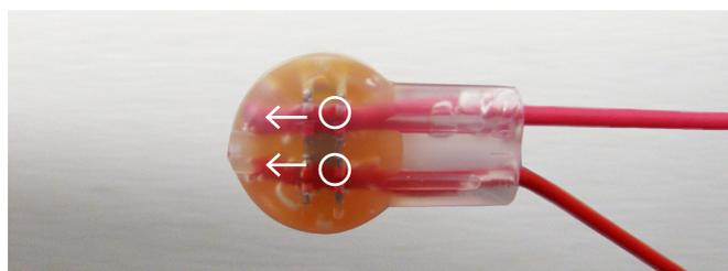
**Important:** Pour une extension de câble, il faut utiliser un câble d'une section de 3 x 0,25 mm<sup>2</sup> (que du câble torsadé, pas de fil mono-brin).
