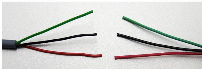
2. Insérer chaque extrémité des deux câbles dans les deux ouvertures du connecteur Scotchlok jusqu'à la butée.
