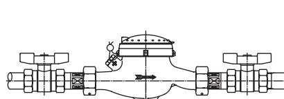
11. In molte installazioni le tubazioni idriche fungono da messa a terra per gli impianti elettrici. In base alla situazione specifica, è possibile che sia necessario garantire una connessione creando un ponte sul contatore d'acqua che in certi casi può interrompere la messa a terra.
