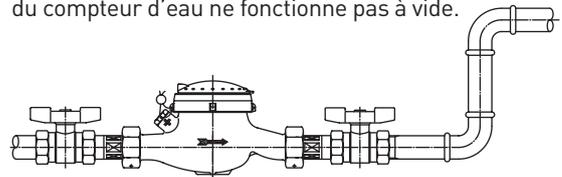
11. Dans beaucoup d'installations, les conduites d'eau servent de masse pour les installations électriques. Dans chaque situation, il faut garantir un pontage électrique du compteur d'eau.
