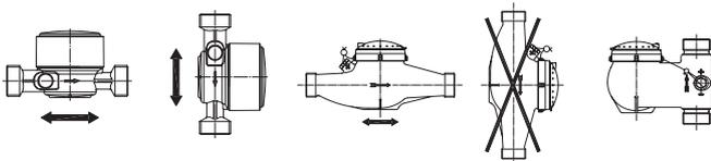
2. Per il contatore d'acqua non è necessaria una tratta di ingresso e di uscita diritta.
