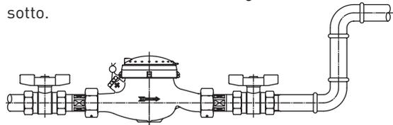
11. In molte installazioni le tubazioni idriche fungono da messa a terra per gli impianti elettrici. In base alla situazione specifica, è possibile che sia necessario garantire una connessione creando un ponte sul contatore d'acqua che in certi casi può interrompere la messa a terra.
