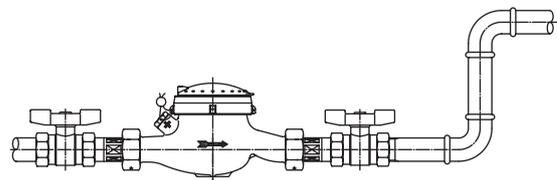
11. Bei vielen Installationen dienen Wasserleitungen als Masse für elektrische Anlagen. Entsprechend der vorliegenden Situation ist eine elektrische Überbrückung des Wasserzählers zu gewährleisten.
