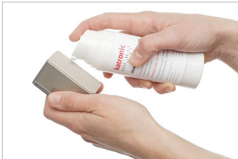
Abb. 7: Auftragen der Ultraschallkoppelpaste auf den Sensorkopf
