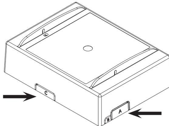
Die mit Buchstaben markierten, perforierten Stege können schnell und flexibel ausgebrochen werden. Somit passt sich die universelle Abdeckhaube an die unterschiedlichen Zählermontageplatten an.
