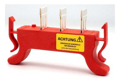
Überbrückungswerkzeug für den spannungsunterbrechungsfreien Smartmeter-/ Energiezähleraustausch. Die Zwangsverrastung auf der Klemme verhindert ein unkontrolliertes Abschalten der Anlage und erhöht die Arbeits- und Betriebssicherheit. Die Klemmschrauben der Zu- und Abgangsleiter sind abgedeckt, sodass eine Fehlbedienung ausgeschlossen ist. Die Ergonomie und Baugröße sind optimal für effizientes und sicheres Arbeiten unter Spannung. Die Montage ist durch eine Elektrofachkraft durchzuführen.
