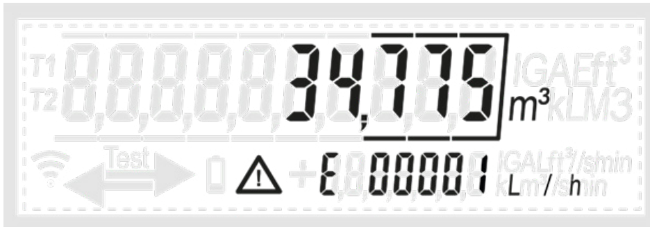
Abb. 20: Die «Luft im Wasser» Fehlermeldung erscheint während der Installation des Zählers
